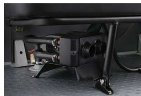
Дополнительный отопитель кабины
